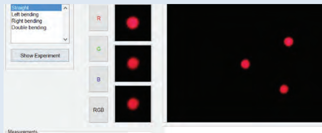
الشكل (6): واجهة المُستخدم الرسومية تُظهر ثلاث دوائر ذات كثافة ضوئية مختلفة يتم تقسيمها ومقارنتها بشكلٍ فردي للتوصّل إلى التنبؤ بالشكل الصحيح.
